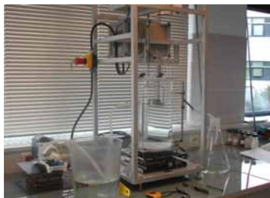
Nouveau dispositif avec entraînement mécanique du bateur
